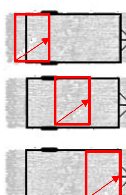
Sonde en position 4 (Arrière droit)
